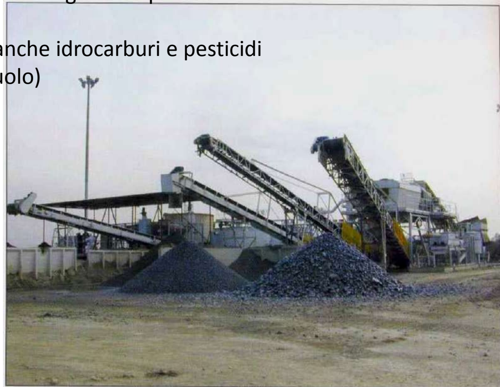
Tav. 4.1 Impianti Enisolvex di soil washing - estrazione con solvente. Uscite del suolo trattato.
